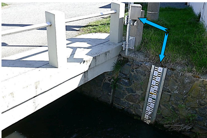
Automatický hlásný profil s vyznačením 1., 2., a 3. SPA (měřící sonda a měrná lať)
