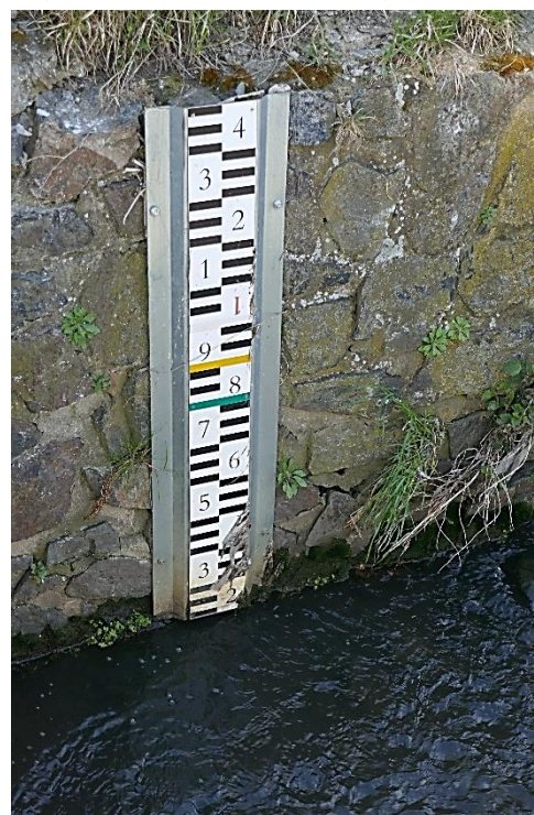
Automatický hlásný profil s vyznačením 1., 2., a 3. SPA (měřící sonda a měrná lať)
